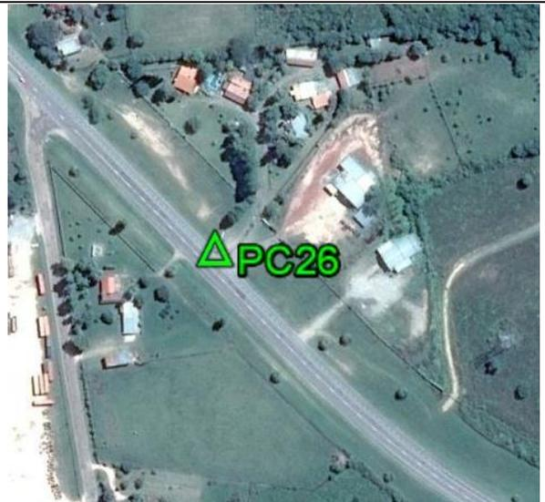
**Fecha: 21/07/2017****Modo de Levantamiento: RTK****Tipo / Modelo de antena utilizado: Trimble/ R8s Internal****Altura / Tipo de Medición de la antena: 2,000 / Base del montaje****Nombre de archivo Rinex: -****Observaciones:** Punto recogido en canto del alcantarillado. Todas las unidades están en metros.**Ejecutado por:****Topocart - Topografía, Engenharia e Aerolevantamento S/S Ltda.**
