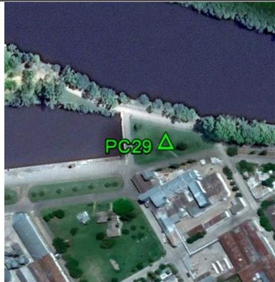
**Fecha: 21/07/2017****Modo de Levantamiento: RTK****Tipo / Modelo de antena utilizado: Trimble/ R8s Internal****Altura / Tipo de Medición de la antena: 2,000 / Base del montaje****Nombre de archivo Rinex: -****Observaciones: El punto fue tomado en la plataforma. Todas las unidades están en metros.****Ejecutado por:****Topocart - Topografía, Engenharia e Aerolevanteamento S/S Ltda.**
