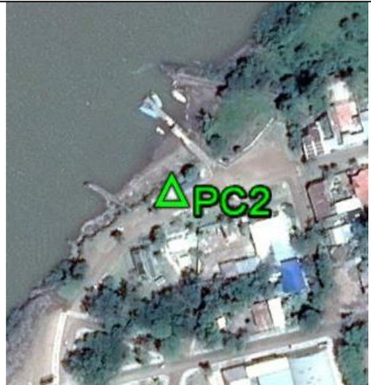
**Fecha: 07/10/2017****Modo de Levantamiento: RTK****Tipo / Modelo de antena utilizado: Trimble/ R8s Internal****Altura / Tipo de Medición de la antena: 2,000 / Base del montaje****Nombre de archivo Rinex: -****Observaciones: Punto recogido sobre la tapa de concreto. Todas las unidades están en metros.****Ejecutado por:****Topocart - Topografía, Engenharia e Aerolevantamento S/S Ltda.**
