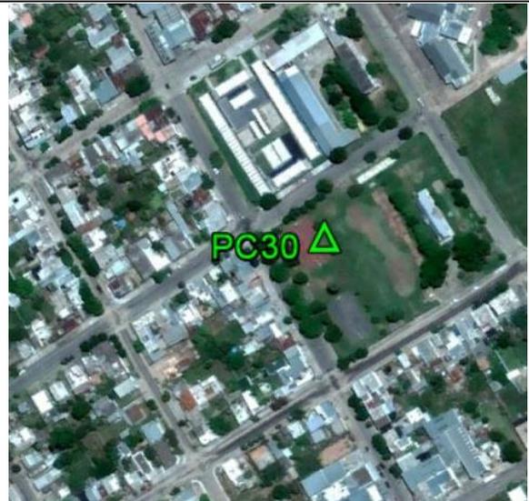
**Fecha: 21/07/2017****Modo de Levantamiento: RTK****Tipo / Modelo de antena utilizado: Trimble/ R8s Internal****Altura / Tipo de Medición de la antena: 2,000 / Base del montaje****Nombre de archivo Rinex: -****Observaciones: Punto recogido en el lateral de la cancha de deportes. Todas las unidades están en metros.****Ejecutado por:****Topocart - Topografía, Engenharia e Aerolevanteamento S/S Ltda.**
