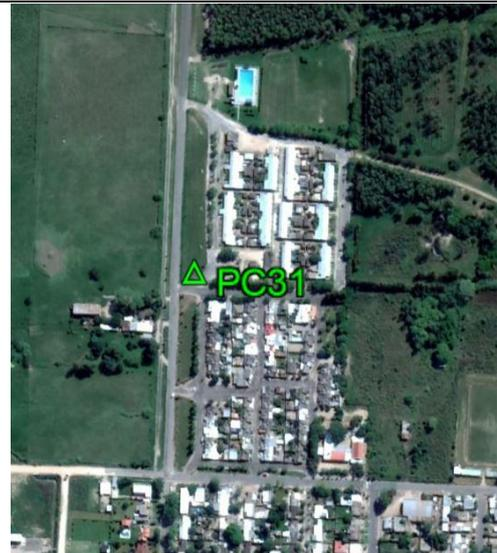
**Fecha: 20/07/2017****Modo de Levantamiento: RTK****Tipo / Modelo de antena utilizado: Trimble/ R8s Internal****Altura / Tipo de Medición de la antena: 2,000 / Base del montaje****Nombre de archivo Rinex: -****Observaciones: Punto fue recogido en la losa. Todas las unidades están en metros.****Ejecutado por:****Topocart - Topografía, Engenharia e Aerolevantamento S/S Ltda.**
