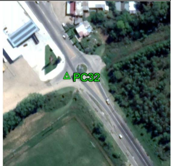
**Fecha: 20/07/2017****Modo de Levantamiento: RTK****Tipo / Modelo de antena utilizado: Trimble/ R8s Internal****Altura / Tipo de Medición de la antena: 2,000 / Base del montaje****Nombre de archivo Rinex: -****Observaciones: Punto recogido en el asfalto. Todas las unidades están en metros.****Ejecutado por:****Topocart - Topografía, Engenharia e Aerolevantamento S/S Ltda.**
