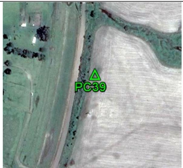
**Fecha: 04/10/2017****Modo de Levantamiento: RTK****Tipo / Modelo de antena utilizado: Trimble/ R8s Internal****Altura / Tipo de Medición de la antena: 2,000 / Base del montaje****Nombre de archivo Rinex: -****Observaciones: Punto recogido en la esquina de la calzada. Todas las unidades están en metros.****Ejecutado por:****Topocart - Topografía, Engenharia e Aerolevantamento S/S Ltda.**
