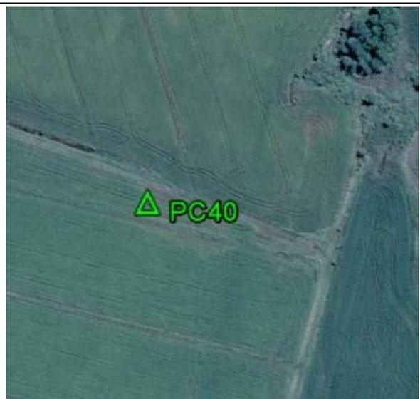
**Fecha: 04/10/2017****Modo de Levantamiento: RTK****Tipo / Modelo de antena utilizado: Trimble/ R8s Internal****Altura / Tipo de Medición de la antena: 2,000 / Base del montaje****Nombre de archivo Rinex: -****Observaciones: Punto recogido en el terreno. Todas las unidades están en metros.****Ejecutado por:****Topocart - Topografía, Ingeniería e Aerolevantamiento S/S Ltda.**
