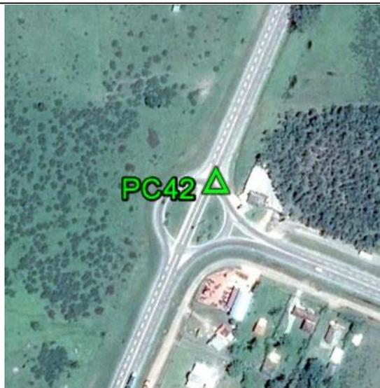
**Fecha: 17/07/2017****Modo de Levantamiento: RTK****Tipo / Modelo de antena utilizado: Trimble/ R8s Internal****Altura / Tipo de Medición de la antena: 2,000 / Base del montaje****Nombre de archivo Rinex: -****Observaciones: Punto recogido en el asfalto. Todas las unidades están en metros.****Ejecutado por:****Topocart - Topografía, Engenharia e Aerolevantamento S/S Ltda.**
