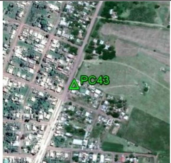
**Fecha: 17/07/2017****Modo de Levantamiento: RTK****Tipo / Modelo de antena utilizado: Trimble/ R8s Internal****Altura / Tipo de Medición de la antena: 2,000 / Base del montaje****Nombre de archivo Rinex: -****Observaciones: Punto recogido en el terreno. Todas las unidades están en metros.****Ejecutado por:****Topocart - Topografía, Engenharia e Aerolevanteamento S/S Ltda.**
