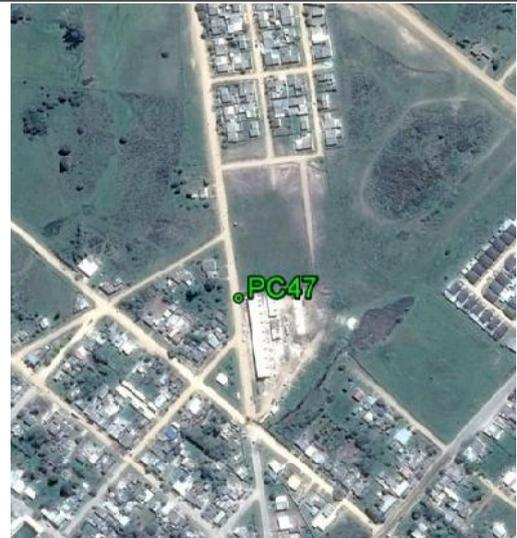
**Fecha: 19/07/2017****Modo de Levantamiento: RTK****Tipo / Modelo de antena utilizado: Trimble/ R8s Internal****Altura / Tipo de Medición de la antena: 2,000 / Base del montaje****Nombre de archivo Rinex: -****Observaciones:** Punto recogido en la esquina de la acera. Todas las unidades están en metros.**Ejecutado por:****Topocart - Topografía, Engenharia e Aerolevantamento S/S Ltda.**
