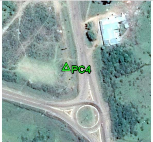
**Fecha: 07/10/2017****Modo de Levantamiento: RTK****Tipo / Modelo de antena utilizado: Trimble/ R8s Internal****Altura / Tipo de Medición de la antena: 2,000 / Base del montaje****Nombre de archivo Rinex: -****Observaciones:** Punto recogido en la esquina de la base de concreto. Todas las unidades están en metros.**Ejecutado por:****Topocart - Topografía, Engenharia e Aerolevanteamento S/S Ltda.**
