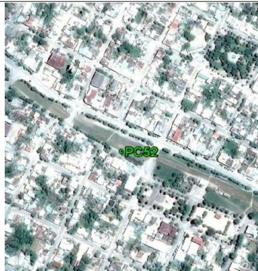
**Fecha: 24/06/2017****Modo de Levantamiento: RTK****Tipo / Modelo de antena utilizado: Trimble/ R8s Internal****Altura / Tipo de Medición de la antena: 2,000 / Base del montaje****Nombre de archivo Rinex: -****Observaciones:** Punto recogido en la esquina de la acera. Todas las unidades están en metros.**Ejecutado por:****Topocart - Topografía, Engenharia e Aerolevantamento S/S Ltda.**
