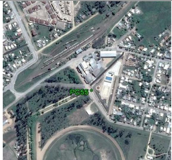
**Fecha: 24/06/2017****Modo de Levantamiento: RTK****Tipo / Modelo de antena utilizado: Trimble/ R8s Internal****Altura / Tipo de Medición de la antena: 2,000 / Base del montaje****Nombre de archivo Rinex: -****Observaciones:** Punto recogido en la esquina de la acera. Todas las unidades están en metros.**Ejecutado por:****Topocart - Topografía, Engenharia e Aerolevantamento S/S Ltda.**
