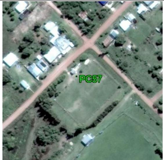
**Fecha: 26/06/2017****Modo de Levantamiento: RTK****Tipo / Modelo de antena utilizado: Trimble / R8s Internal****Altura / Tipo de Medición de la antena: 2,000 / Base del montaje****Nombre de archivo Rinex: -****Observaciones: Punto recogido en la junta del piso. Todas las unidades están en metros.****Ejecutado por:****Topocart - Topografía, Engenharia e Aerolevantamento S/S Ltda.**
