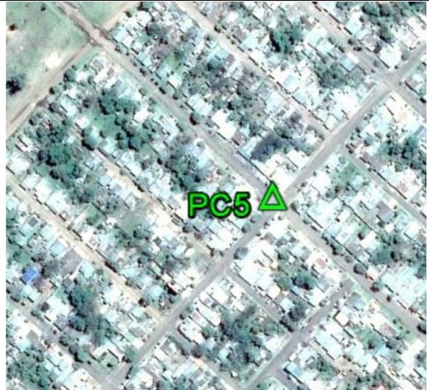
**Fecha: 07/10/2017****Modo de Levantamiento: RTK****Tipo / Modelo de antena utilizado: Trimble/ R8s Internal****Altura / Tipo de Medición de la antena: 2,000 / Base del montaje****Nombre de archivo Rinex: -****Observaciones: Punto recogido en el asfalto. Todas las unidades están en metros.****Ejecutado por:****Topocart - Topografía, Engenharia e Aerolevantamento S/S Ltda.**
