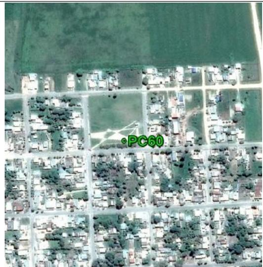
**Fecha: 20/07/2017****Modo de Levantamiento: RTK****Tipo / Modelo de antena utilizado: Trimble/ R8s Internal****Altura / Tipo de Medición de la antena: 2,000 / Base del montaje****Nombre de archivo Rinex: -****Observaciones: Punto recogido en la esquina de la acera. Todas las unidades están en metros.****Ejecutado por:****Topocart - Topografía, Engenharia e Aerolevantamento S/S Ltda.**
