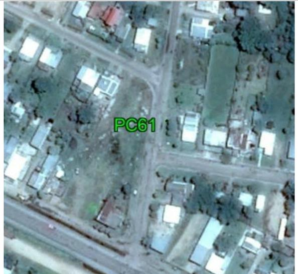
**Fecha: 26/06/2017****Modo de Levantamiento: RTK****Tipo / Modelo de antena utilizado: Trimble / R8s Internal****Altura / Tipo de Medición de la antena: 2,000 / Base del montaje****Nombre de archivo Rinex: -****Observaciones:** Punto recogido en una base de hormigón. Todas as unidades están e metros.**Ejecutado por:****Topocart - Topografía, Engenharia e Aerolevantamento S/S Ltda.**
