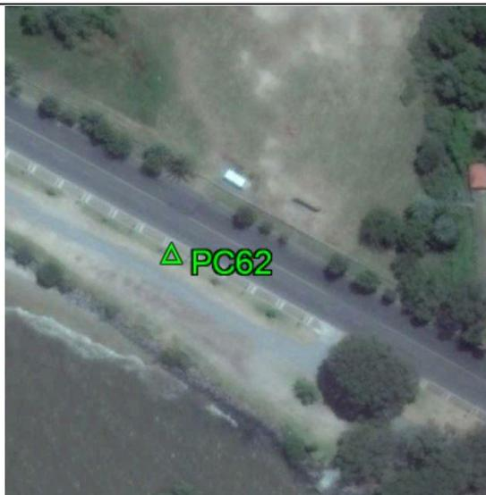
**Fecha: 04/10/2017****Modo de Levantamiento: RTK****Tipo / Modelo de antena utilizado: Trimble/ R6-4 Internal****Altura / Tipo de Medición de la antena: 2,000 / Base del montaje****Nombre de archivo Rinex: -****Observaciones: Punto recogido en el terreno. Todas las unidades están en metros.****Ejecutado por:****Topocart - Topografía, Engenharia e Aerolevantamento S/S Ltda.**
