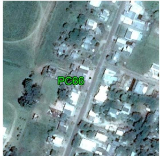
**Fecha: 28/06/2017****Modo de Levantamiento: RTK****Tipo / Modelo de antena utilizado: Trimble / R8s Internal****Altura / Tipo de Medición de la antena: 2,000 / Base del montaje****Nombre de archivo Rinex: -****Observaciones:** Punto recogido en uno piso de hormigón. Todas las unidades están en metros.**Ejecutado por:****Topocart - Topografía, Engenharia e Aerolevantamento S/S Ltda.**
