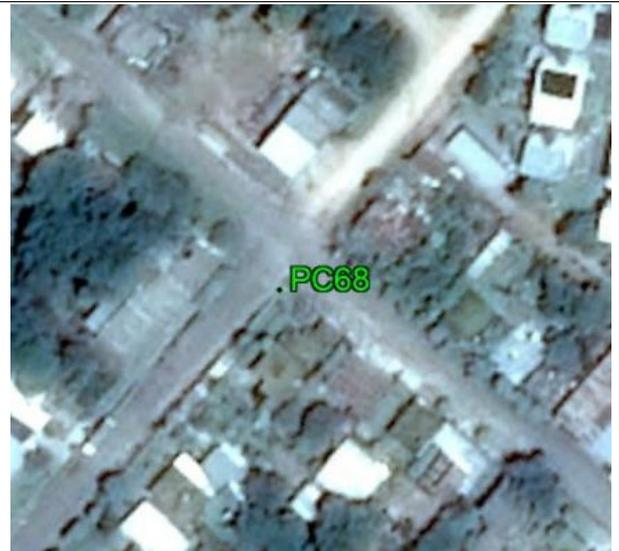
**Fecha: 28/06/2017****Modo de Levantamiento: RTK****Tipo / Modelo de antena utilizado: Trimble / R8s Internal****Altura / Tipo de Medición de la antena: 2,000 / Base del montaje****Nombre de archivo Rinex: -****Observaciones:** Punto recogido en la acera .Todas las unidades están en metros.**Ejecutado por:****Topocart - Topografía, Engenharia e Aerolevantamento S/S Ltda.**
