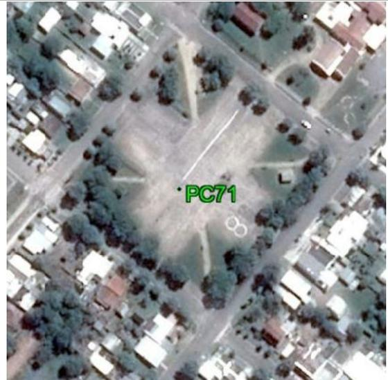
**Fecha: 27/06/2017****Modo de Levantamiento: RTK****Tipo / Modelo de antena utilizado: Trimble / R8s Internal****Altura / Tipo de Medición de la antena: 2,000 / Base del montaje****Nombre de archivo Rinex: -****Observaciones: Punto recogido en el suelo pavimentado. Todas las unidades están en metros.****Ejecutado por:****Topocart - Topografía, Engenharia e Aerolevantamento S/S Ltda.**
