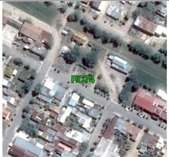
**Fecha: 28/08/2017****Modo de Levantamiento: RTK****Tipo / Modelo de antena utilizado: Trimble / R8s Internal****Altura / Tipo de Medición de la antena: 2,000 / Base del montaje****Nombre de archivo Rinex: -****Observaciones:** Punto recogido en la esquina de la acera. Todas as unidades están en metro.**Ejecutado por:****Topocart - Topografía, Engenharia e Aerolevantamento S/S Ltda.**
