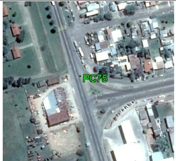
**Fecha: 28/08/2017****Modo de Levantamiento: RTK****Tipo / Modelo de antena utilizado: Trimble / R8s Internal****Altura / Tipo de Medición de la antena: 2,000 / Base del montaje****Nombre de archivo Rinex: -****Observaciones: Punto recogido en el suelo pavimentado. Todas las unidades están en metros.****Ejecutado por:****Topocart - Topografía, Engenharia e Aerolevantamento S/S Ltda.**
