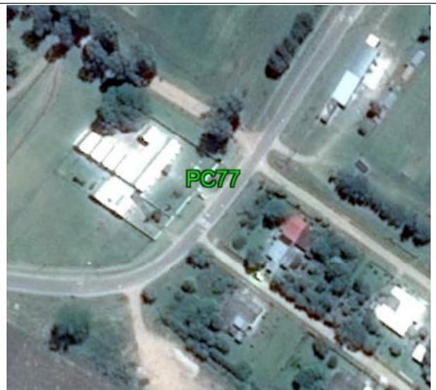
**Fecha: 23/06/2017****Modo de Levantamiento: RTK****Tipo / Modelo de antena utilizado: Trimble / R8s Internal****Altura / Tipo de Medición de la antena: 2,000 / Base del montaje****Nombre de archivo Rinex: -****Observaciones:** Punto recogido en la esquina de la acera. Todas las unidades están en metros.**Ejecutado por:****Topocart - Topografía, Engenharia e Aerolevantamento S/S Ltda.**
