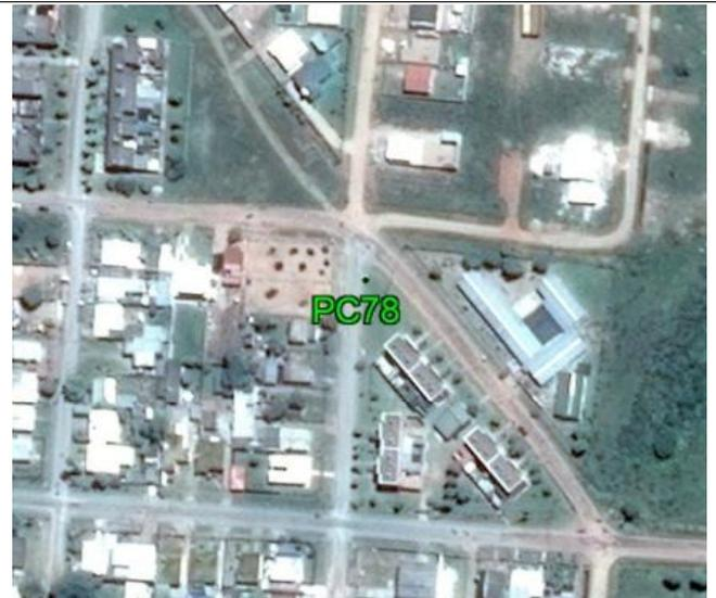
**Fecha: 23/06/2017****Modo de Levantamiento: RTK****Tipo / Modelo de antena utilizado: Trimble / R8s Internal****Altura / Tipo de Medición de la antena: 2,000 / Base del montaje****Nombre de archivo Rinex: -****Observaciones:** Punto recogido en la esquina de la tapas de alcantarillado. Todas las unidades están en metros.**Ejecutado por:****Topocart - Topografía, Engenharia e Aerolevantamento S/S Ltda.**
