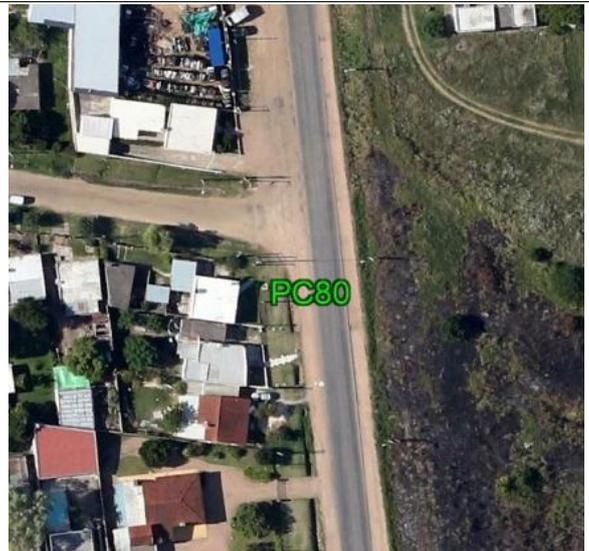
**Fecha: 08/07/2017****Modo de Levantamiento: RTK****Tipo / Modelo de antena utilizado: Trimble / R8s Internal****Altura / Tipo de Medición de la antena: 2,000 / Base del montaje****Nombre de archivo Rinex: -****Observaciones:** Punto recogido en la esquina de una base de hormigón. Todas las unidades están en metros.**Ejecutado por:****Topocart - Topografía, Engenharia e Aerolevantamento S/S Ltda.**
