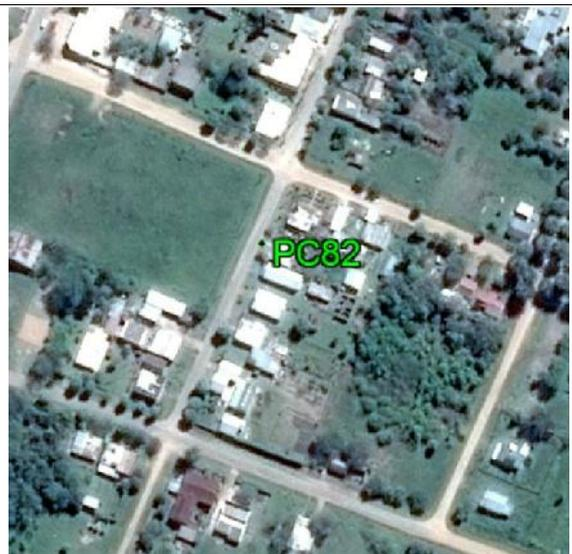
**Fecha: 22/06/2017****Modo de Levantamiento: RTK****Tipo / Modelo de antena utilizado: Trimble / R8s Internal****Altura / Tipo de Medición de la antena: 2,000 / Base del montaje****Nombre de archivo Rinex: -****Observaciones:** Punto recogido en la esquina de la acera. Todas las unidades están en metros.**Ejecutado por:****Topocart - Topografía, Engenharia e Aerolevantamento S/S Ltda.**
