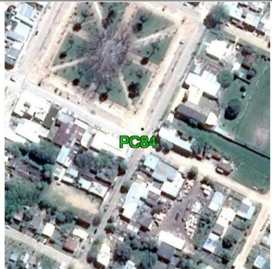
**Fecha: 22/06/2017****Modo de Levantamiento: RTK****Tipo / Modelo de antena utilizado: Trimble / R8s Internal****Altura / Tipo de Medición de la antena: 2,000 / Base del montaje****Nombre de archivo Rinex: -****Observaciones: Punto recogido en el terreno. Todas las unidades están en metros.****Ejecutado por:****Topocart - Topografía, Engenharia e Aerolevanteamento S/S Ltda.**
