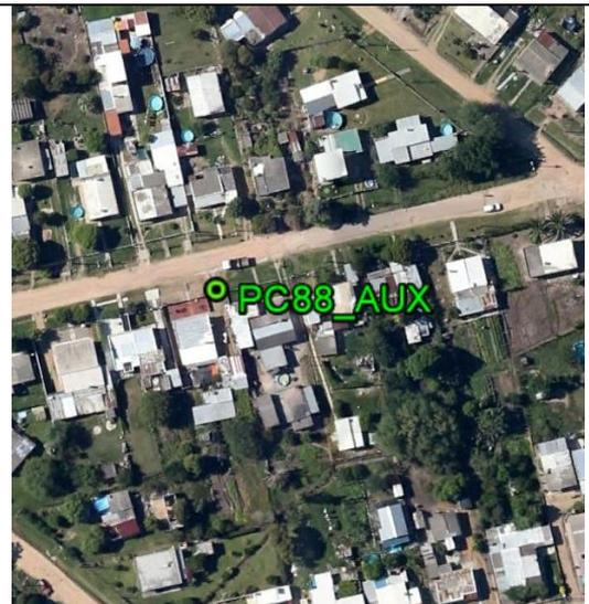
**Fecha: 28/09/2017****Modo de Levantamiento: Estático****Tipo / Modelo de antena utilizado: Trimble/ R6-4 Internal****Altura / Tipo de Medición de la antena: 2,000 / Base del montaje****Nombre de archivo Rinex: PC88\_AUX\_2712****Observaciones: Punto recogido en la esquina de una base de hormigón. Todas las unidades están en metros.****Ejecutado por:****Topocart - Topografía, Engenharia e Aerolevantamento S/S Ltda.**
