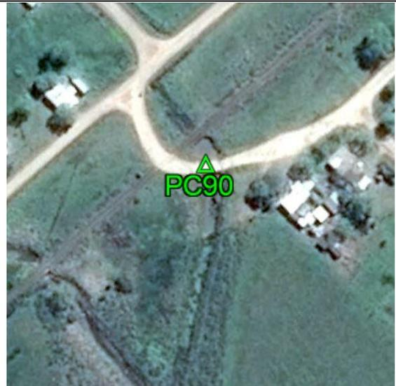
**Fecha: 25/06/2017****Modo de Levantamiento: RTK****Tipo / Modelo de antena utilizado: Trimble/ R8s Internal****Altura / Tipo de Medición de la antena: 2,000 / Base del montaje****Nombre de archivo Rinex: -****Observaciones: Punto recogido en la esquina del medio hilo del puente. Todas las unidades están en metros.****Ejecutado por:****Topocart - Topografía, Engenharia e Aerolevanteamento S/S Ltda.**
