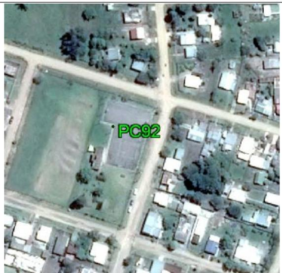
**Fecha: 22/06/2017****Modo de Levantamiento: RTK****Tipo / Modelo de antena utilizado: Trimble / R8s Internal****Altura / Tipo de Medición de la antena: 2,000 / Base del montaje****Nombre de archivo Rinex: -****Observaciones:** Punto recogido en el suelo pavimentado. Todas las unidades están en metros.**Ejecutado por:****Topocart - Topografía, Engenharia e Aerolevantamento S/S Ltda.**
