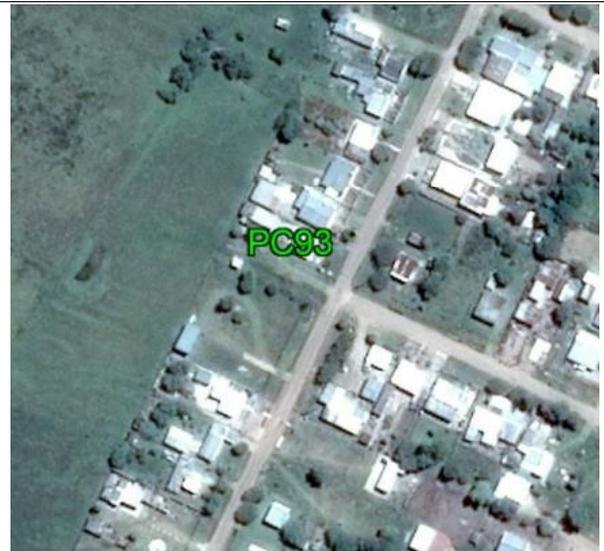
**Fecha: 22/06/2017****Modo de Levantamiento: RTK****Tipo / Modelo de antena utilizado: Trimble / R8s Internal****Altura / Tipo de Medición de la antena: 2,000 / Base del montaje****Nombre de archivo Rinex: -****Observaciones:** Punto recogido en la esquina de la acera. Todas las unidades están en metros.**Ejecutado por:****Topocart - Topografía, Engenharia e Aerolevantamento S/S Ltda.**
