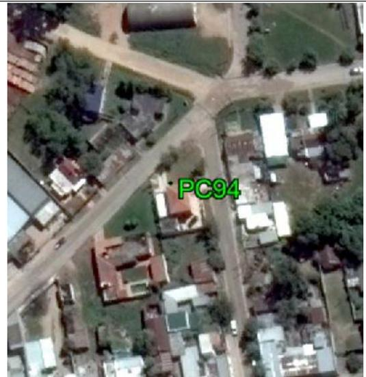
**Fecha: 23/06/2017****Modo de Levantamiento: RTK****Tipo / Modelo de antena utilizado: Trimble / R8s Internal****Altura / Tipo de Medición de la antena: 2,000 / Base del montaje****Nombre de archivo Rinex: -****Observaciones:** Punto recogido en el piso de hormigón. Todas las unidades están en metros.**Ejecutado por:****Topocart - Topografía, Engenharia e Aerolevantamento S/S Ltda.**
