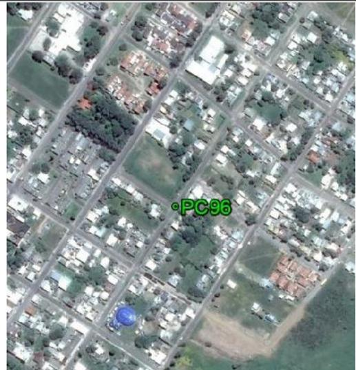
**Fecha: 25/06/2017****Modo de Levantamiento: RTK****Tipo / Modelo de antena utilizado: Trimble/ R8s Internal****Altura / Tipo de Medición de la antena: 2,000 / Base del montaje****Nombre de archivo Rinex: -****Observaciones: Punto recogido en la esquina de la base de hormigón. Todas las unidades están en metros.****Ejecutado por:****Topocart - Topografía, Engenharia e Aerolevantamento S/S Ltda.**
