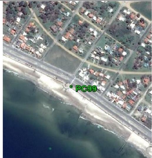
**Fecha: 21/07/2017****Modo de Levantamiento: RTK****Tipo / Modelo de antena utilizado: Trimble/ R8s Internal****Altura / Tipo de Medición de la antena: 2,000 / Base del montaje****Nombre de archivo Rinex: -****Observaciones:** Punto recogido en la esquina de la acera. Todas las unidades están en metros.**Ejecutado por:****Topocart - Topografía, Engenharia e Aerolevantamento S/S Ltda.**
